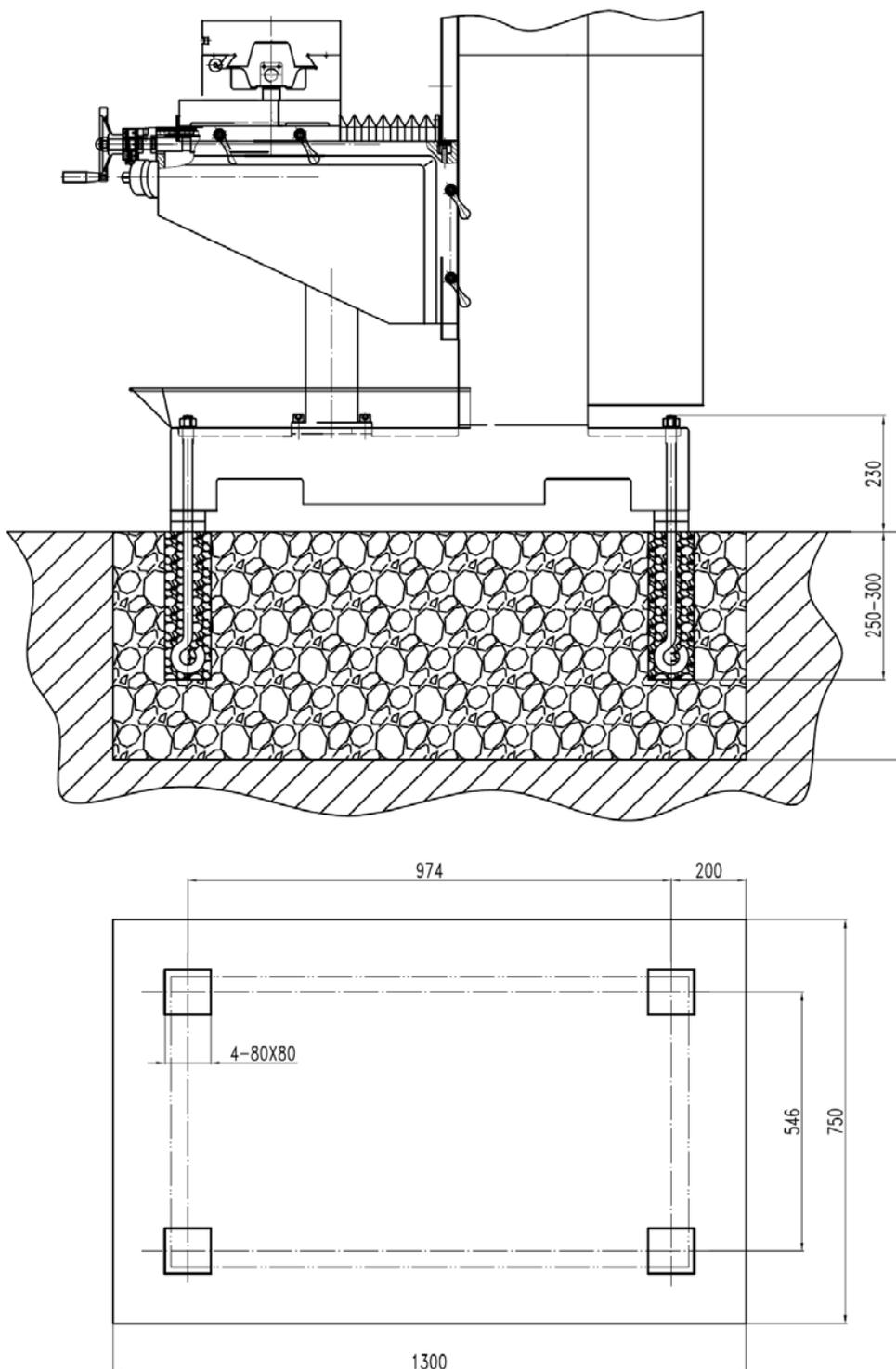
Отрегулируйте уровень станка таким образом, чтобы допуск неплоскостности не превышал 0,04 мм / 1000 мм в поперечном и горизонтальном направлении после крепления станка четырьмя фундаментными болтами. При необходимости, установите проставки.
