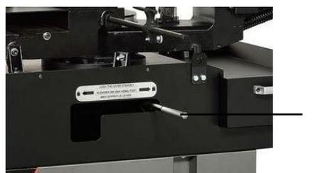
На станке возможна отрезка под углом под углом до 60° (вправо) и 45° (влево). Отрегулируйте угол пильной рамы, как указано ниже:
