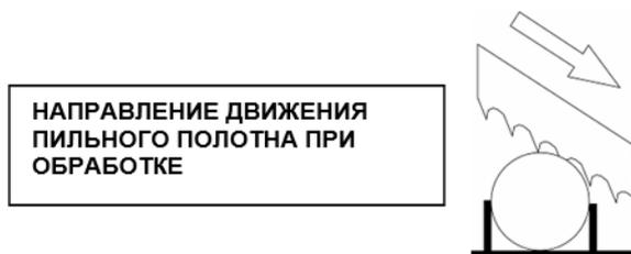
**ВНИМАНИЕ:** Всегда устанавливайте на станок пыльное полотно с размерами, указанными в данной инструкции, и для которого настроены направляющие блоки. В случае установки пыльного полотна другого размера см. пункт 5.2 Регулировка хода пыльного полотна на шкивах и в направляющих блоках
