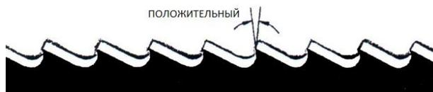
Используется для поперечного или наклонного распила цельных заготовок или больших труб, но прежде всего для твердых материалов (высоколегированные и нержавеющие стали, специальная бронза и ковкий чугун).
