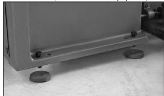
Рис.13. Выравнивание ножек и винтов Для выравнивания станка используйте точный уровень, удостоверьтесь, что направляющие станины выровнены слева-направо и от передней части к задней.
