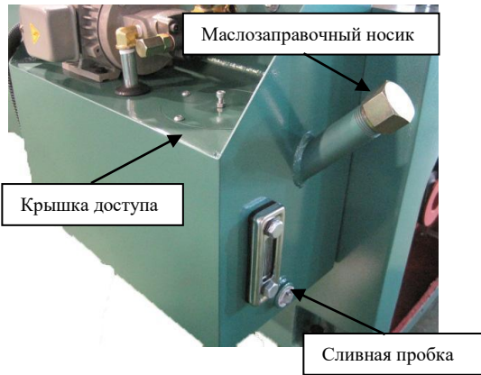
Рис. 72. Расположение элементов масляного резервуара передней бабки.
